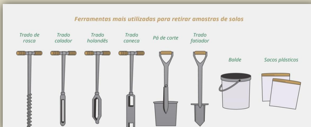
Imagem 15: Ferramentas mais utilizadas para retirar amostras de solos. Fonte: Site gasparim.com.br.
